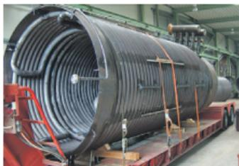
Die Henkel Rohrverformungstechnik GmbH stellt Rohrwärmetauscher und Rohrkomponenten für Anlagen der Wärmeerzeugung, -rückgewinnung, der chemischen Industrie und der Prozesstechnik her. Unsere Produkte werden individuell in aufwendiger Handarbeit hergestellt.
